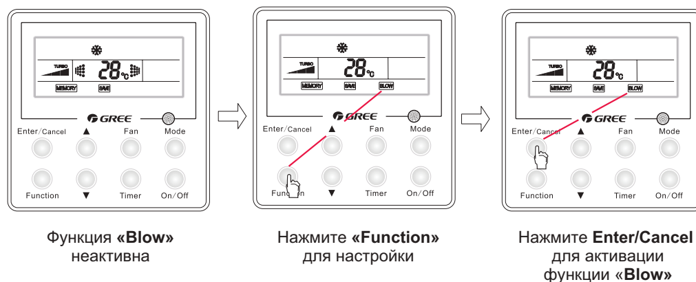
Рис. 20 Активация функции самоочистки
