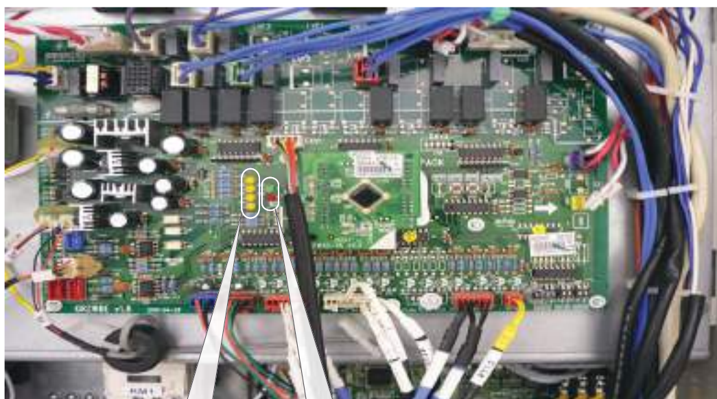
Рис. Основная плата наружного блока
