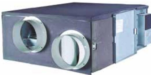
Приточно-вытяжные установки с рекуперацией тепла обеспечивают подачу наружного свежего воздуха и вытяжку воздуха из помещения. Это идеальное решение задачи вентиляции помещений как жилого, так и коммерческого типа. Блок рекуперации обеспечивает одновременный обмен скрытого и явного тепла, что позволяет регулировать температуру и влажность. Благодаря использованию пластинчатого рекуператора может быть сэкономлено до 70% энергии.
