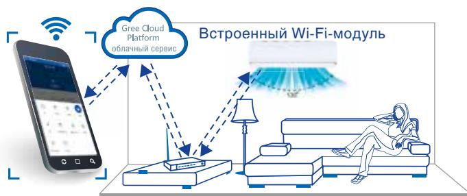
При успешной настройке связи между кондиционером и пользовательским аккаунтом пользователь сможет войти в приложение и управлять кондиционером через любое устройство с установленным приложением
