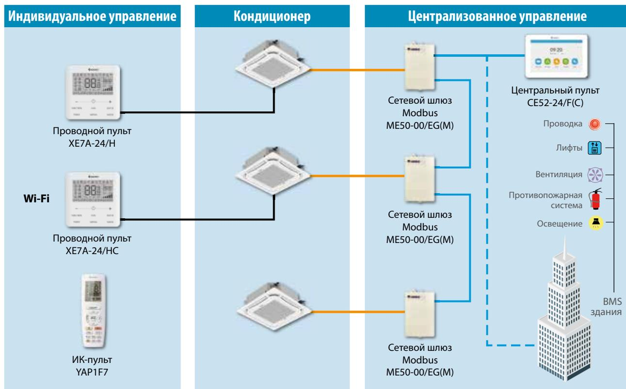
**Примечание:** Кассетные внутренние блоки использованы в качестве примера. Данная схема актуальна для внутренних блоков любого типа.
