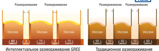
Работа кондиционера в режиме обогрева стала еще более комфортной благодаря сокращению времени на размораживание.
