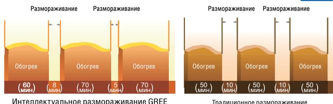
Работа кондиционера в режиме обогрева стала еще более комфортной благодаря сокращению времени на размораживание.
